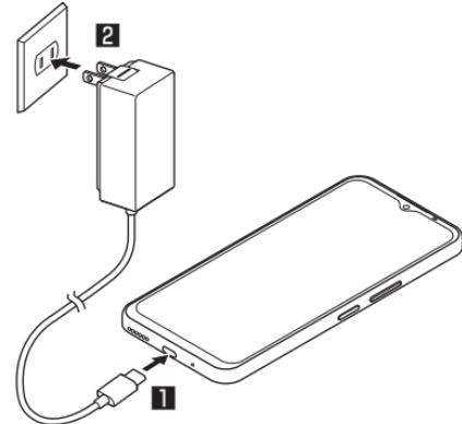
③ 充電が完了したら、ACアダプタの電源プラグをコンセントから抜き、ACアダプタのUSB Type-C プラグを本機から取り外す
