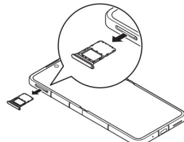
**3 USIMカードのIC（金属）面を下にして、USIMカードトレイに取り付ける**
